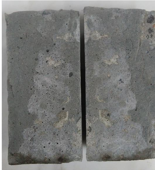
Ao compararem-se os dois materiais de reparo analisados neste trabalho, observa-se a superioridade dos valores obtidos para a argamassa modificada em relação à argamassa sem adição. A Figura 3 ilustra a comparação entre os resultados obtidos para a argamassa sem adição e a argamassa modificada por polímero acrílico.
