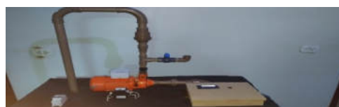
Figura 25 - Sistema de segurança para verificação de escorva do conjunto motobomba.
