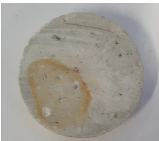
Figura 2 – Mancha de coloração marrom em corpo de prova contendo 5% de pirita aos 28 dias.
