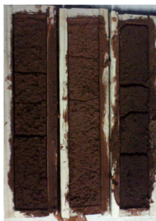
Figura 3: Ensaio de retração linear
